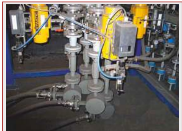
Pneumatische Dosierung mit Regulierung der einzelnen Linien bei mehreren Massenströmen
