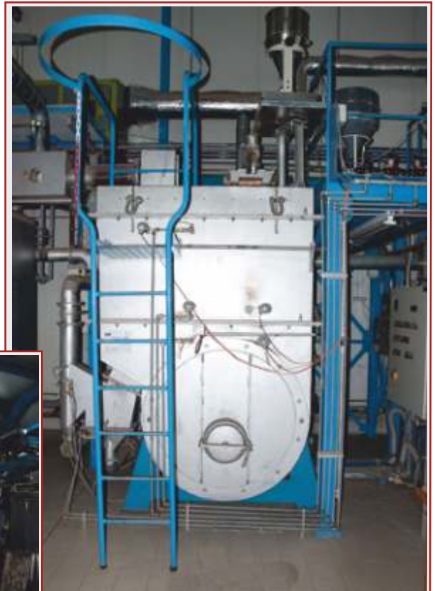
Hochtemperatur-Wirbelschicht-Reaktor (bis 1.300 °C)
