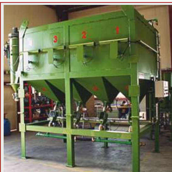
Vorratsbehälter für 4 Gießpulver
