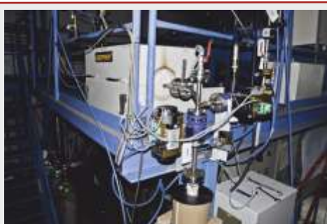
Rohröfen zur Erhitzung des Sauerstoffs
