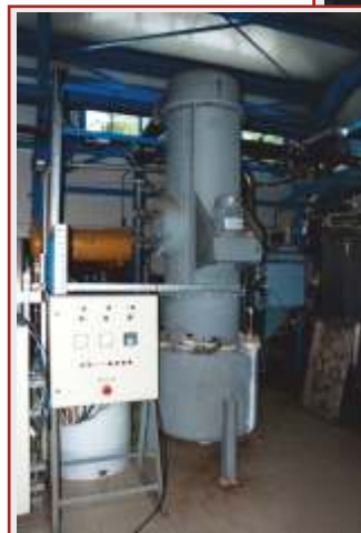
Hochtemperatur-Wirbelschicht-Reaktor (bis 1.300 °C)
