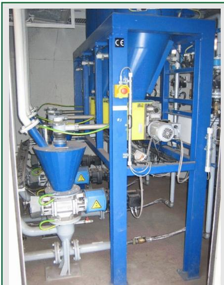
*Dosierbehälter mit Dosierschnecken*
