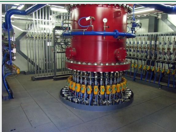
*Verteilergefäß für 32 Förderleitungen*
