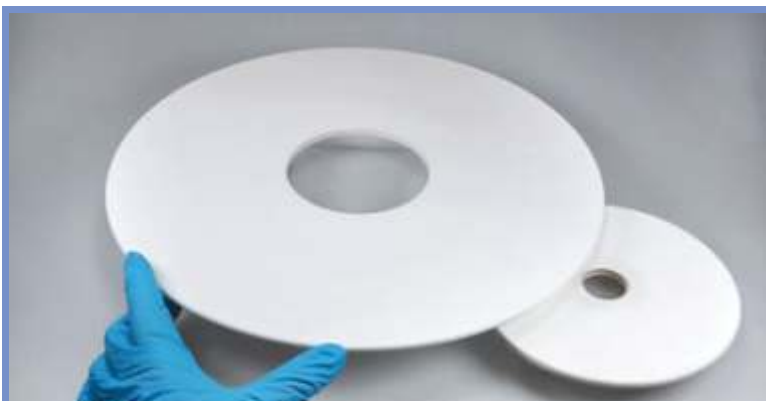
Neuartige keramische Rotationsscheibenfilter mit NF-Beschichtung zur Erprobung in Abwasserströmen
